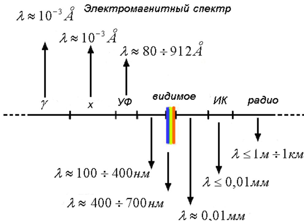
**Рис. 30.** Распределение волн электромагнитного спектра по длине волны
