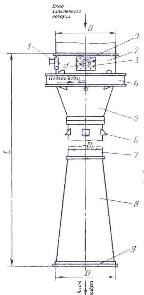
**Рис. 18.** Труба Вентури: 1 – лаз геометрический, 2 – цилиндр, 3 – смывное приспособление, 4 – камера, 5 – конфузор, 6 – опора, 7 – горловина, 8 – диффузор, 9 – фланец
