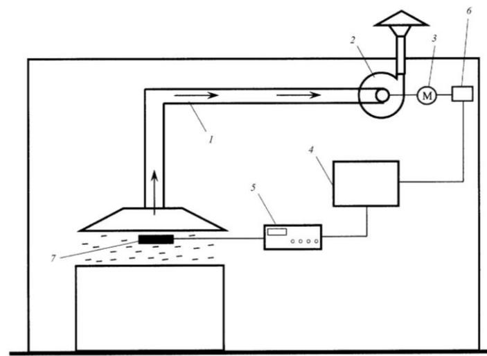
**Рис. 21.** Система вентиляции промышленного предприятия: 1 – вытяжной воздуховод загрязненного воздуха, 2 – вентилятор, 3 – электродвигатель, 4 – регулятор расхода воздуха, 5 – датчик концентрации вредных веществ в воздухе рабочей зоны, 6 – преобразователь частоты вращения электродвигателя, 7 – газозаборный зонд
