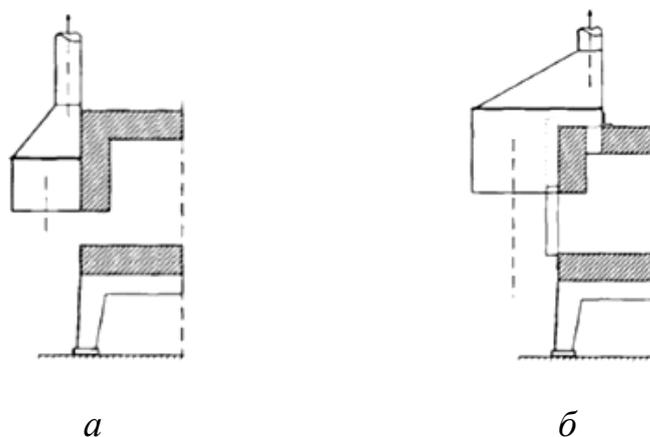
**Рис. 11.** Зонты-козырьки у нагревательных печей: а – у щелевого отверстия при выпуске через него продуктов горения; б – у отверстия снабженного дверкой при выпуске продуктов горения через газовые окна
