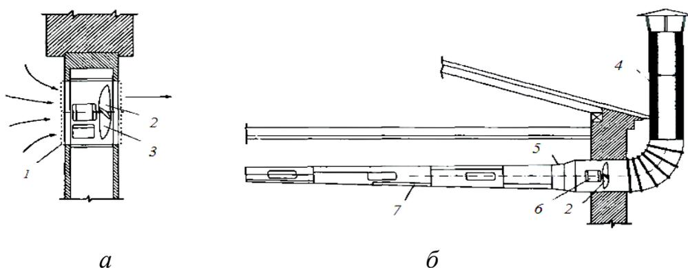
**Рис. 8.** Канальные и бесканальные системы вентиляции: *а* – бесканальные системы, *б* – канальные системы; 1 – утепленный клапан, 2 – вентилятор, 3 – лопасти вентилятора, 4 – вытяжная шахта, 5 – шибер, 6 – электродвигатель, 7 – вытяжная сеть
