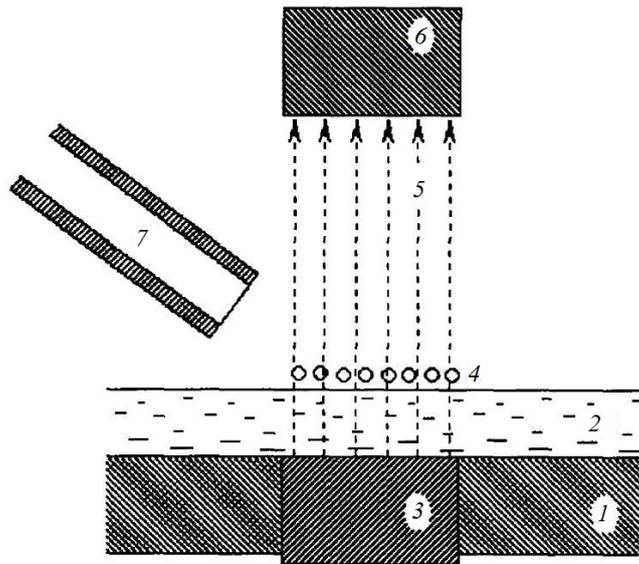
**Рис. 26.** Способ контроля запыленности воздуха: 1 – кювета, 2 – тонкий слой жидкости, 3 – светоизлучающий нагревательный элемент, 4 – капельный кластер, 5 – световой поток, 6 – фотоприемник, 7 – воздуховод
