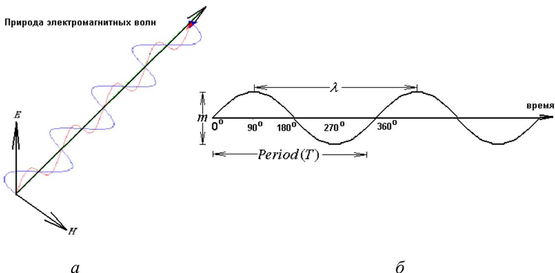
**Рис. 29.** Электромагнитное излучение: а – природа электромагнитного излучения; б – физические характеристики излучения
