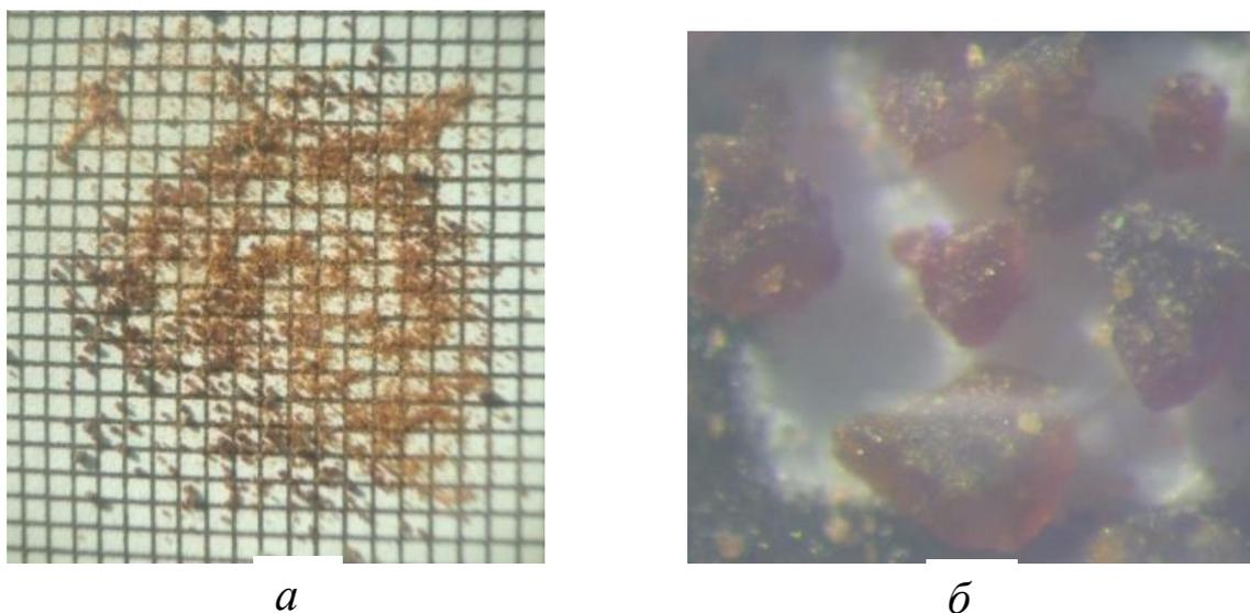
**Рис. 1.** Микрофотографии пыли: *а* – общий вид осажденной пыли на поверхности при увеличении 4,8×; *б* – при увеличении 56× одной из областей. Распределенная на аналитических фильтрах пыль считается по элемен-
