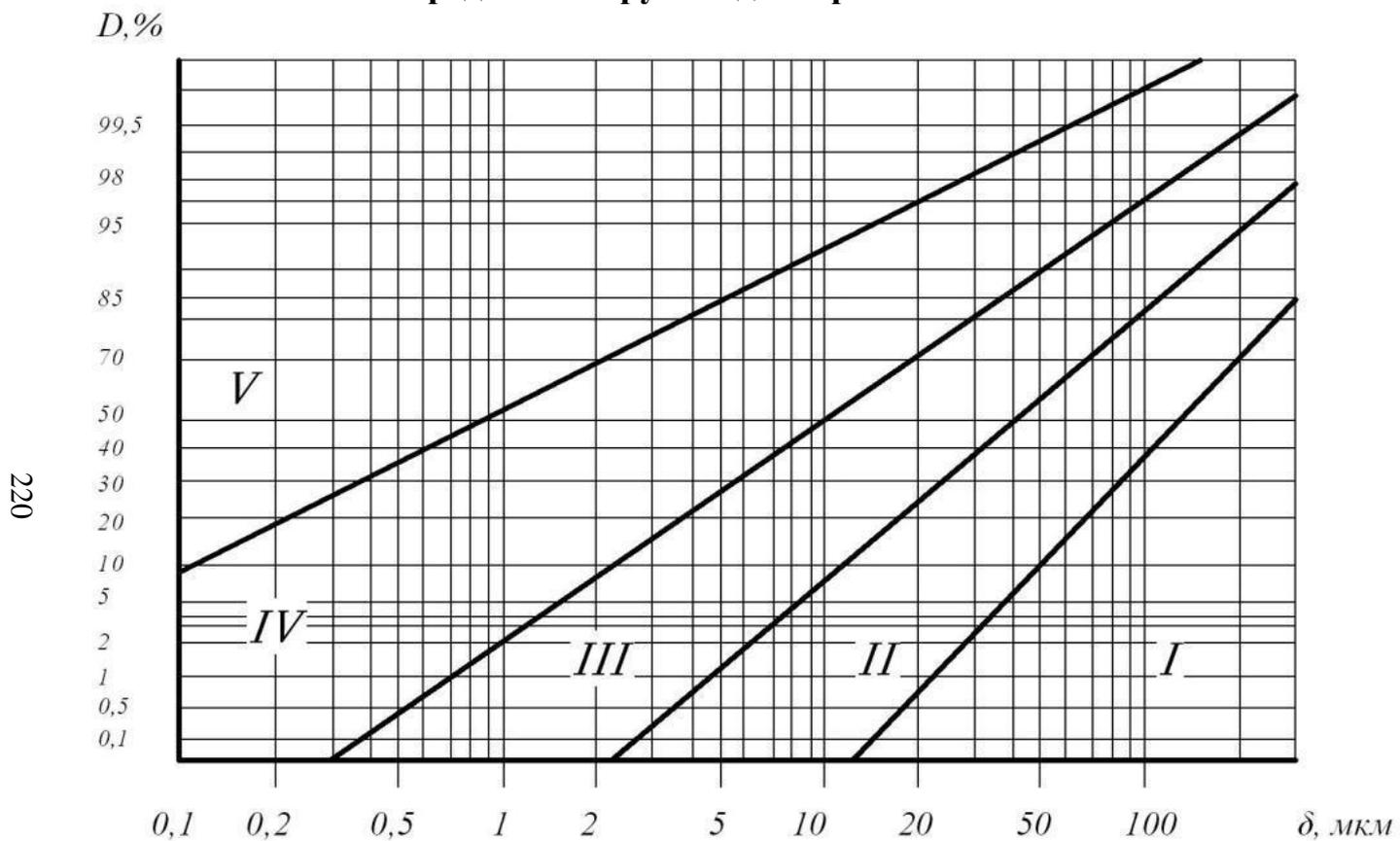
Рис. Б.1. Номограмма для определения группы дисперсности пыли
