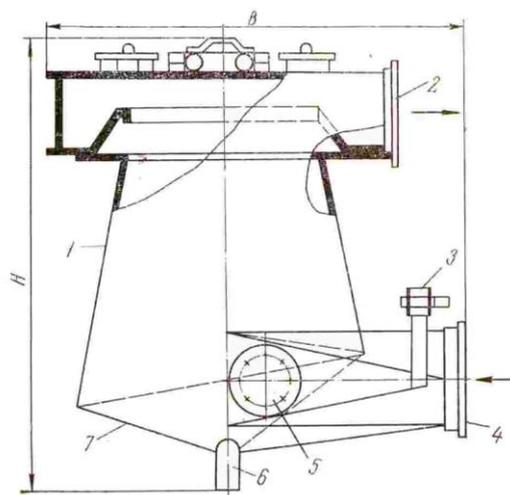
**Рис. 16.** Циклон-промыватель СИОТ: 1 – корпус, 2 – патрубок для выхода воздуха, 3 - водоподводящая трубка, 4 – патрубок для входа воздуха, 5 – смотровые люки, 6 – спускной клапан, 7 – коническая часть циклона
