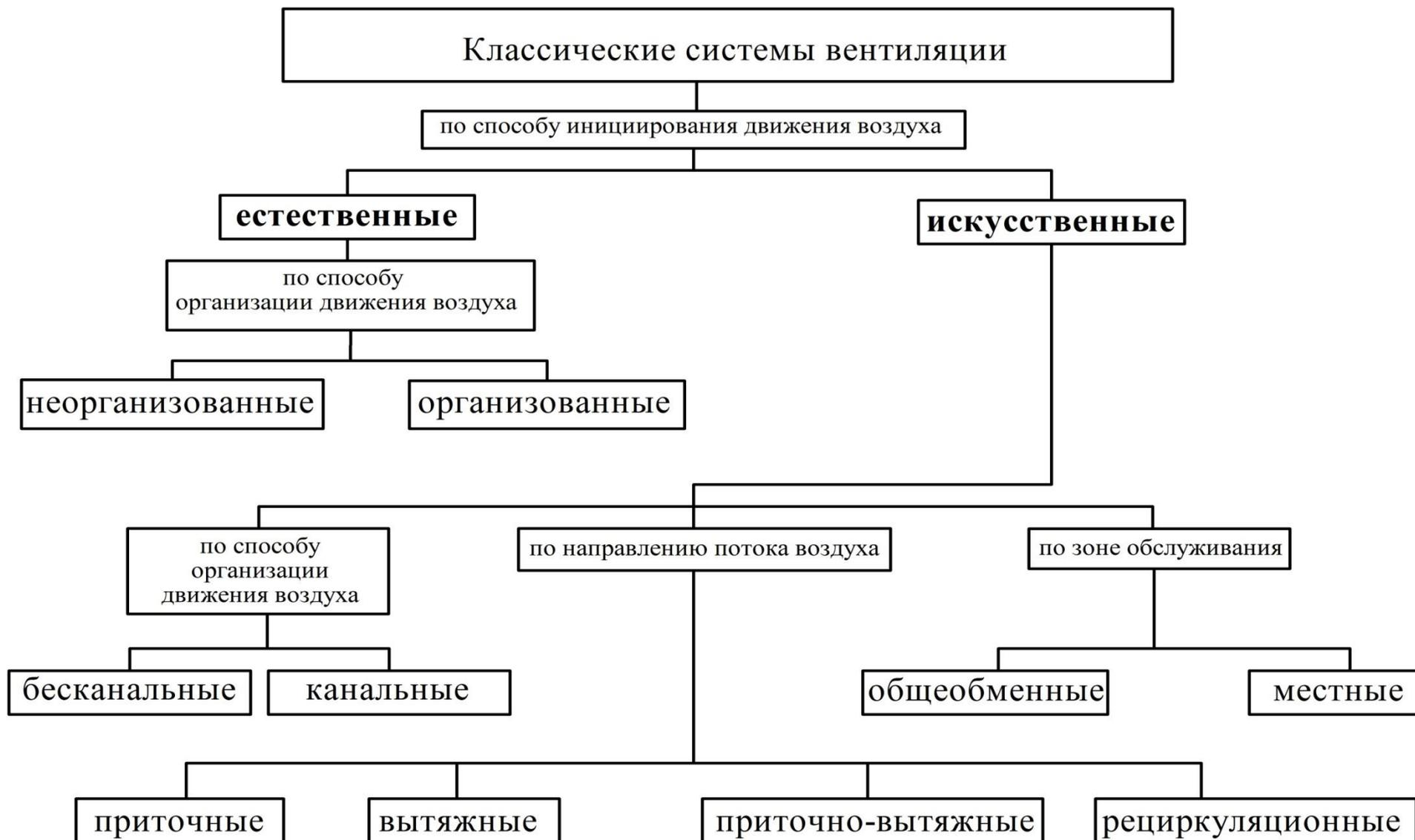
*Рис. 4.* Классификация существующих систем вентиляции
