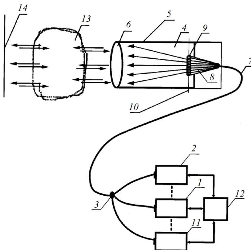
**Рис. 25.** Оптическое устройство контроля производственной атмосферы:
