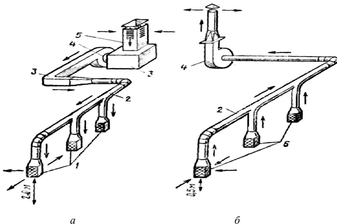
**Рис. 9.** Схемы приточной и вытяжной систем вентиляции: *а* – приточная вентиляция, *б* – вытяжная вентиляция; 1 – воздухораспределители, 2 – воздуховоды, 3 – калорифер, 4 – вентилятор, 5 – воздухозаборная шахта, 6 – воздухоприемники
