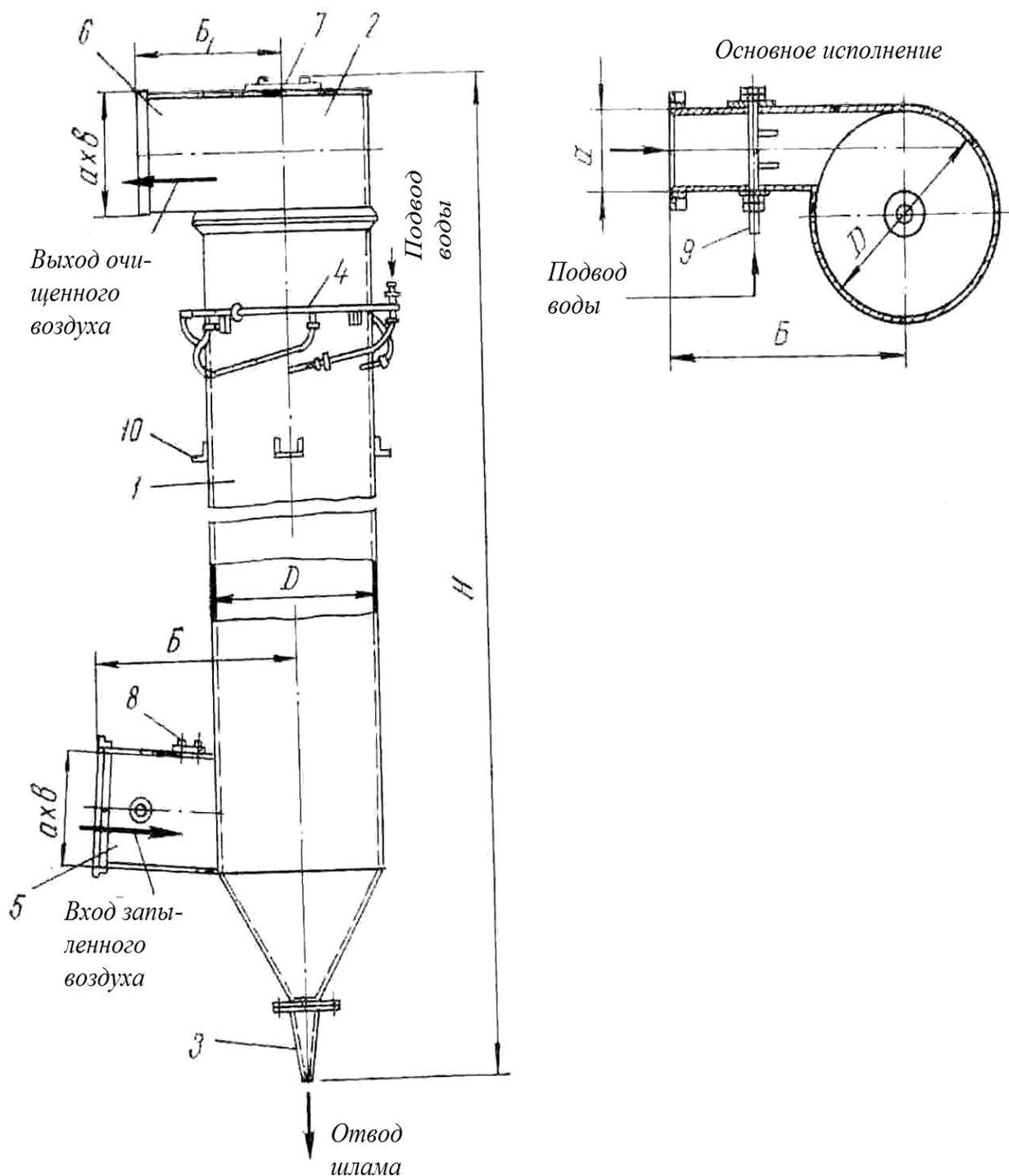
**Рис. 15.** Циклон с водяной пленкой ЦВП: 1 – корпус, 2 – улитка, 3 – конусный патрубок (гидрозатвор), 4 – коллектор, 5 – входной патрубок, 6 – выходной патрубок, 7 – люк, 8 – лючок, 9 – смывное приспособление, 10 – опора
