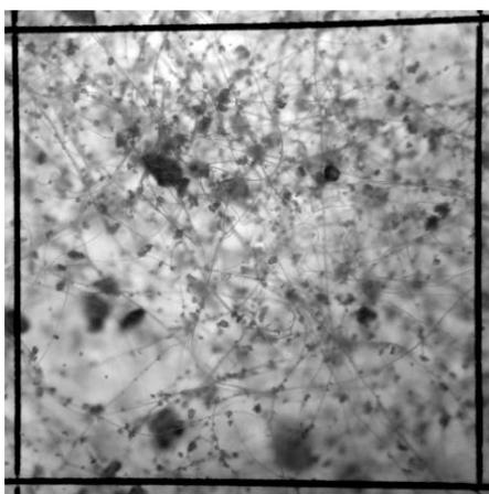
**Рис. 2.** Микрофотография аналитического фильтра с пробой пыли
