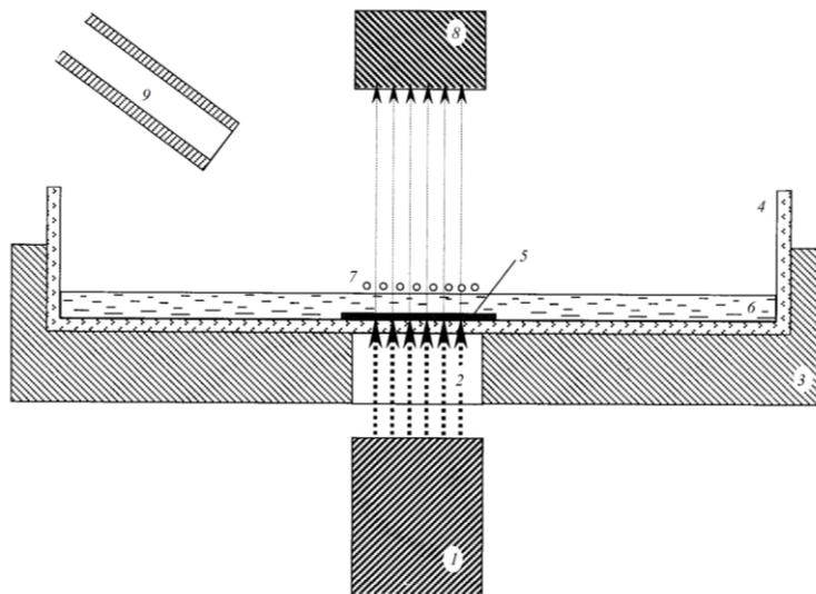
**Рис. 27.** Измеритель запыленности воздуха: 1 – источник света, 2 – коллимированный световой пучок, 3 – основание, 4 – сменная кювета, 5 – участок поверхности дна, 6 – слой жидкости, 7 – капельный кластер, 8 – фотоприемник; 9 – трубка для подачи воздуха
