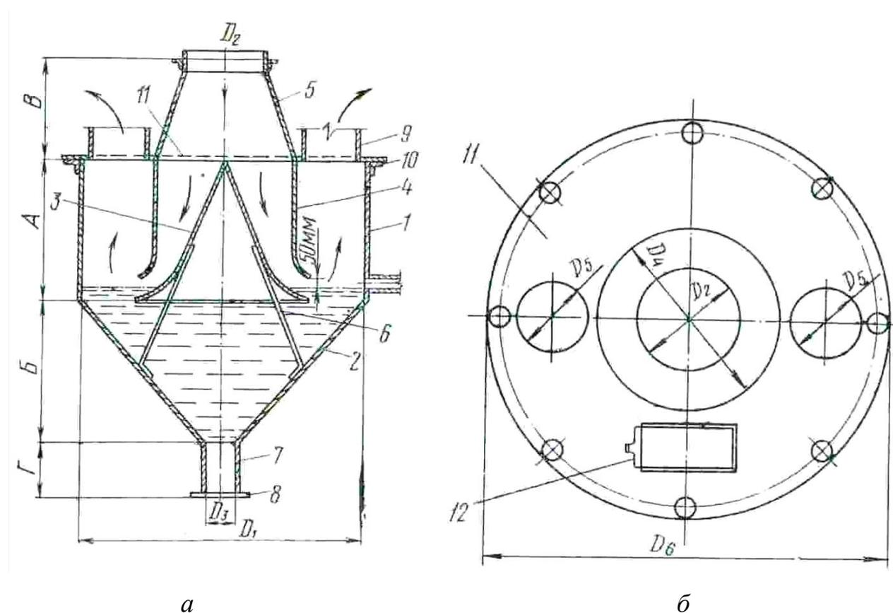
**Рис. 19.** Мокрый пылеуловитель РИСИ: *а* – разрез пылеуловителя, *б* – вид сверху; 1 – цилиндрическая камера, 2 – бункер конической формы, 3 – конус-рассекатель, 4 – отражатель, 5 – диффузор, 6 – лапка, 7 – патрубок для отвода шлама, 8 – фланец, 9 – патрубок для отвода очищенного воздуха, 10 – уголок, 11 – крышка, 12 – шибер
