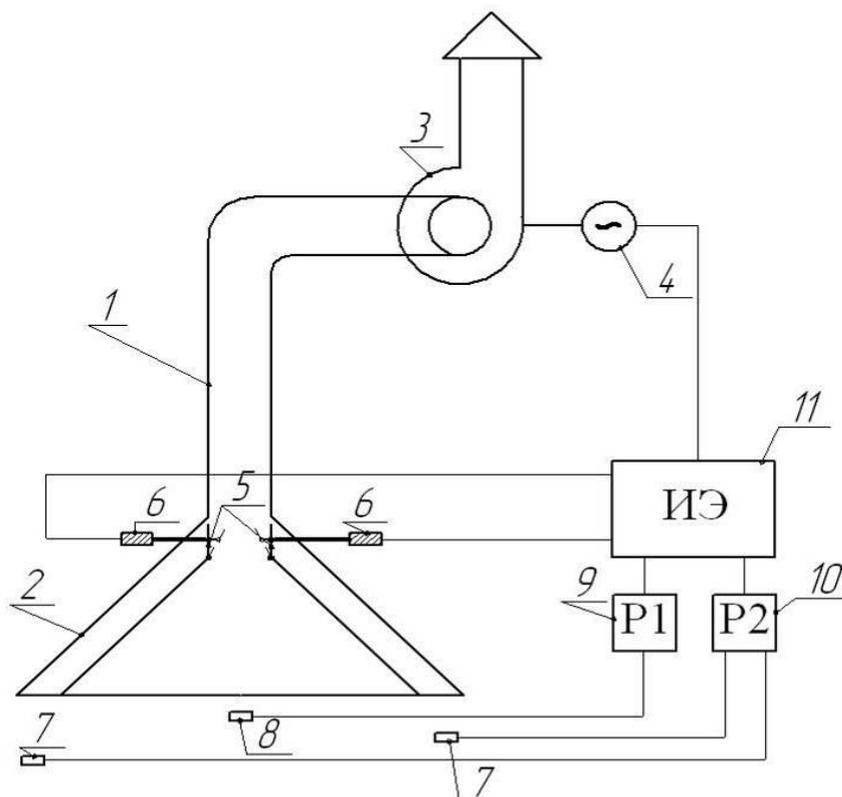
**Рис. 23.** Схема вентиляции промышленного предприятия: 1 – вытяжной воздуховод загрязненного воздуха, 2 – внешний вытяжной воздуховод загрязненного воздуха, 3 – вентилятор, 4 – электродвигатель, 5 – заслонки, 6 – электромагнитные исполнительные органы, 7 – внешние датчики концентрации вредных веществ, 8 – датчик концентрации вредных веществ, 9 и 10 – двухпозиционные регуляторы концентрации, 11 – исполнительный элемент
