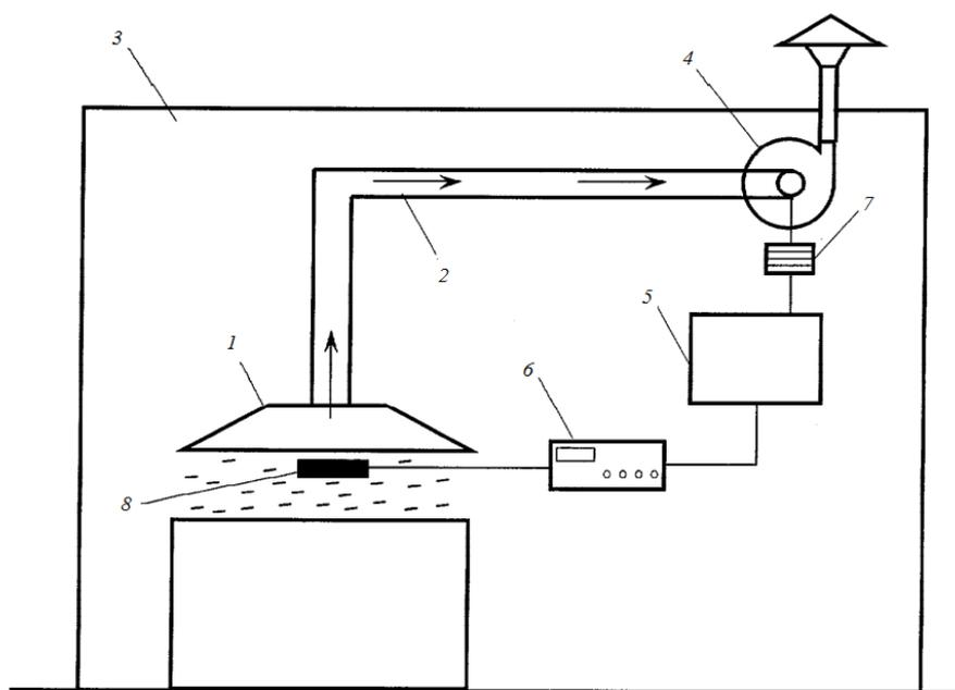
**Рис. 20.** Способ вентиляции промышленного предприятия: 1 – воздуховоды местных отсосов загрязненного воздуха, 2 – основной воздуховод вытяжной вентиляции, 3 – производственный цех, 4 – вытяжной вентилятор, 5 – регулятор расхода воздуха, 6 – газоанализатор концентрации вредных веществ в воздухе рабочей зоны, 7 – исполнительный механизм, 8 – газозаборный зонд
